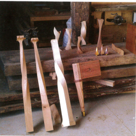
Grâce à sa machine inédite, Damien Fréneau peut réaliser des vrilles dans le bois sans avoir recours à la sculpture. © Damien Fréneau.
